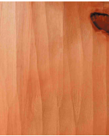
□鎗鉋で仕上げられた扉の表面（左）と鎗鉋で仕上げる様子：木の表面を押しながら削るので、表面が密実になり水をよくはじくという
