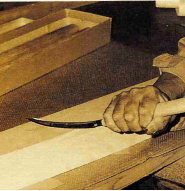
□鎗鉋で仕上げられた扉の表面（左）と鎗鉋で仕上げる様子：木の表面を押しながら削るので、表面が密実になり水をよくはじくという
