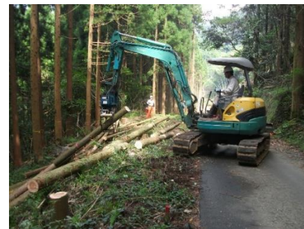
間伐木搬出作業
