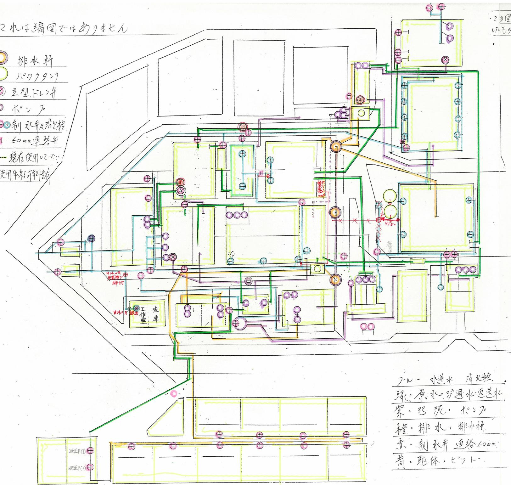
この図は理設配管、制水弁、消火栓などを主に記載したもので、鉛管のハーブル配管は記載していません。
