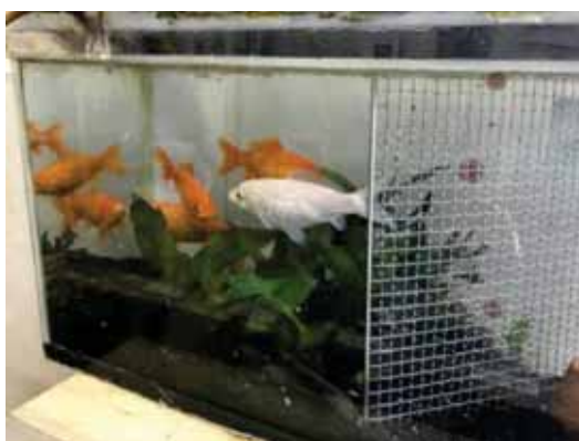
写真 4.1.2 魚を用いた検知用水槽
