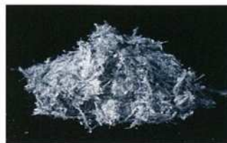
青石綿(クロシドライト)
