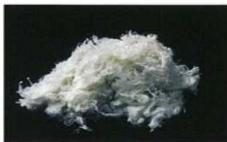
白石綿(クリソタイル)
