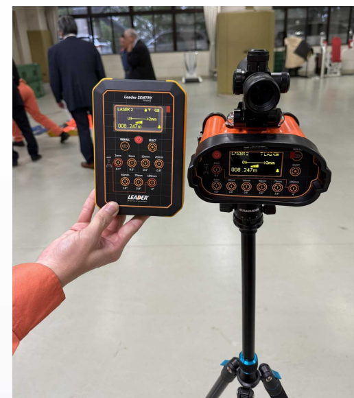
【 崩落監視システム 】
