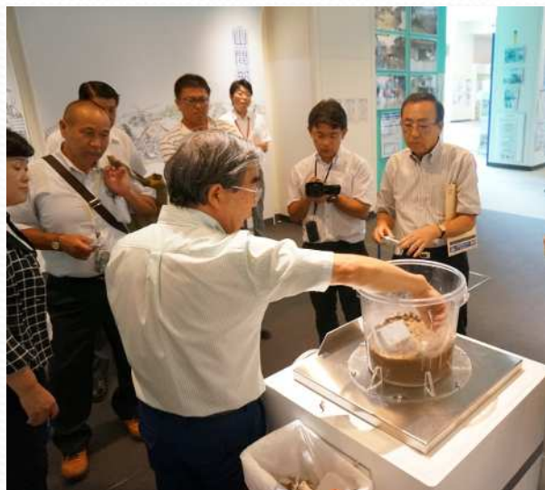
液状化実験装置
